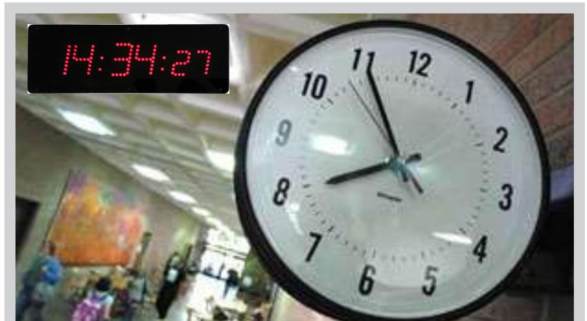
Merkezi saat sistemleri; bir ana merkez saat ve buna bağlı olarak çalışan , dijital ve analog tali saat ünitelerinden oluşmaktadır. Yan saatler, sadece bir merkezi saate bağlı olduğunda çalışabilir. Merkezi saat, sürekli olarak GPS ile aldığı zaman bilgisi ile kendini senkronize eder ve en yüksek doğrulukta kalır. Saatler; yerleştirilecek mekanların büyülüklük ve yerine göre istenilen ebatlarda ve değişik şekillerde özel olarak tasarlanmaktadır.
